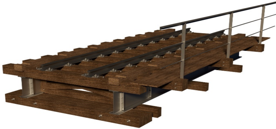
Рис. 2. Общий вид деревянного мостового бруса
